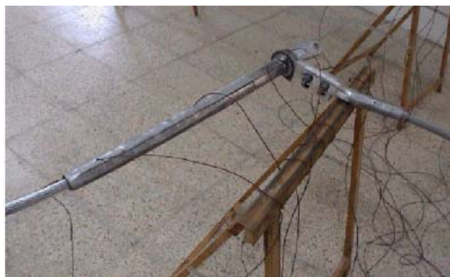
FIGURA 7 - Termopares en la grapa de compresión
